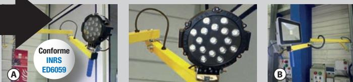
La mise en place d'un éclairage additionnel permet d'éclairer les zones les plus dangereuses et de supprimer les contrastes lumineux nécessitant un temps d'adaptation de la pupille, source potentielle de danger. Produit CE conforme aux directives suivantes : Directive 2004/108/CE - Directive 2006/95/CE - Directive 2011/65/CE
