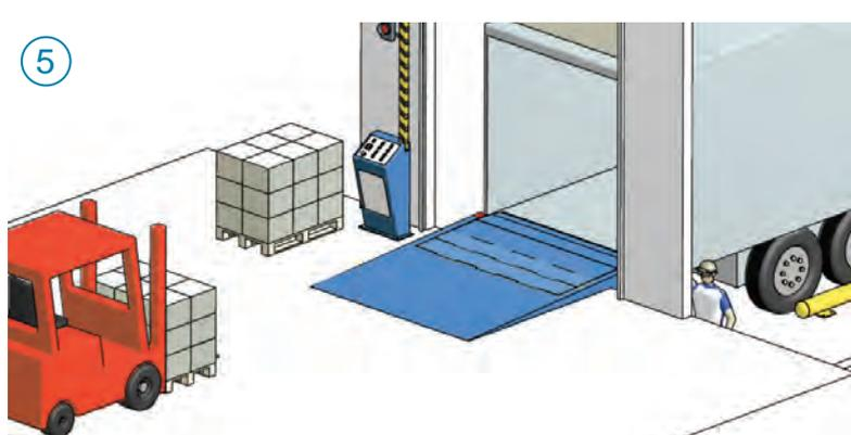
Ensuite, la lèvre de liaison peut être déployée sur le plancher de la remorque afin de finir les opérations de chargement ou déchargement.
