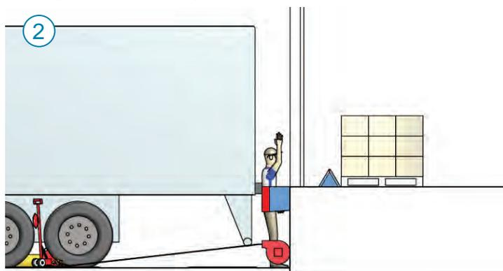
La personne est protégée grâce au **refuge de 500 mm**. De plus, situé en arrière de la porte, l'obstacle du niveleur en plus de sa **fonction antichute**, protège également la porte des palettes posées en attente sur le plateau du niveleur.
