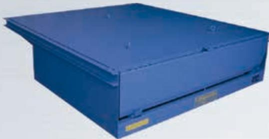
Le niveleur présente dans sa partie supérieure un cadre périphérique avec pattes de scellement sur 3 côtés, qui sera posé sur la feuillure prévue autour de la fosse. Les pattes de scellement sont soudées sur les "ronds à béton" en attente, puis le béton est coulé à fleur avec le dallage.
