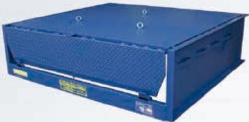
Le niveleur est entièrement caissonné sur 3 côtés qui sont munis de pattes de scellement. Il se pose sur un radier avec des fers à béton en attente sur les 3 côtés qui seront soudés sur les pattes de scellement puis remplis de béton.
